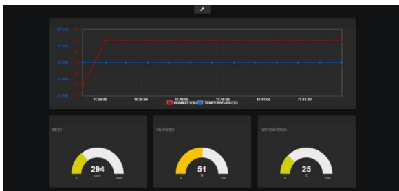
ภาพที่ 10 แสดงหน้าจอแสดงข้อมูลเซนเซอร์บนเน็ตพายผ่านคอมพิวเตอร์
